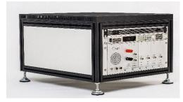
基于瞬态热测试技术的功率循环设备 CX-PC,利用功率循环方式测试功率元件之热可靠性与生命周期。
