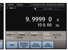
左图:利用分流器模式,可以查看直接的绝对 电流测量值以及电压测量值。
