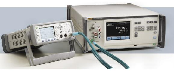
新的 5790B 宽带选 件扩展了可校准的负荷范 围,能够校准射频功率计, 例 如 Keysight N1914A, 的 50 MHz 参考输出。
